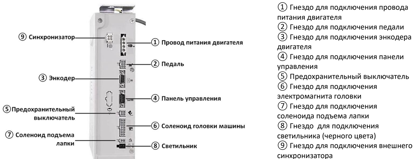
Рис. 1-2 Схема подключений блока управления
