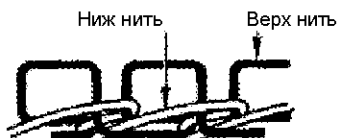
Ослабленные, плохие стежки получаются, когда верхняя нить не затянута
