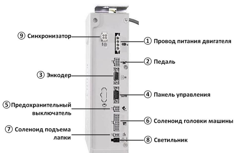
Рис. 1-2 Схема подключений блока управления
