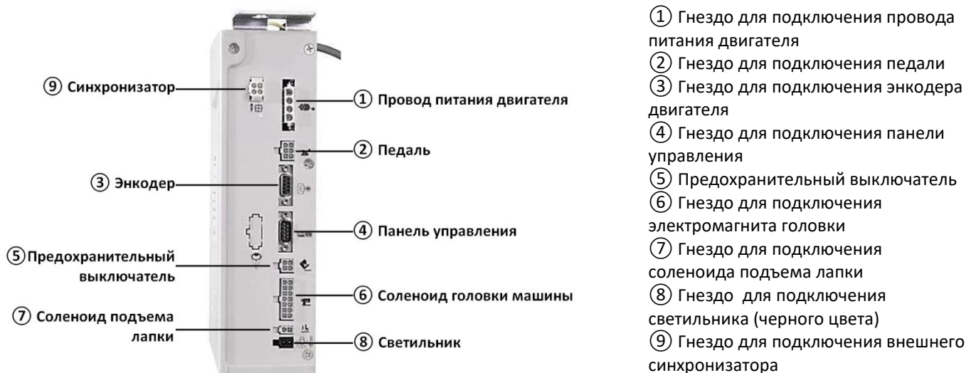
Рис. 1-2 Схема подключений блока управления
