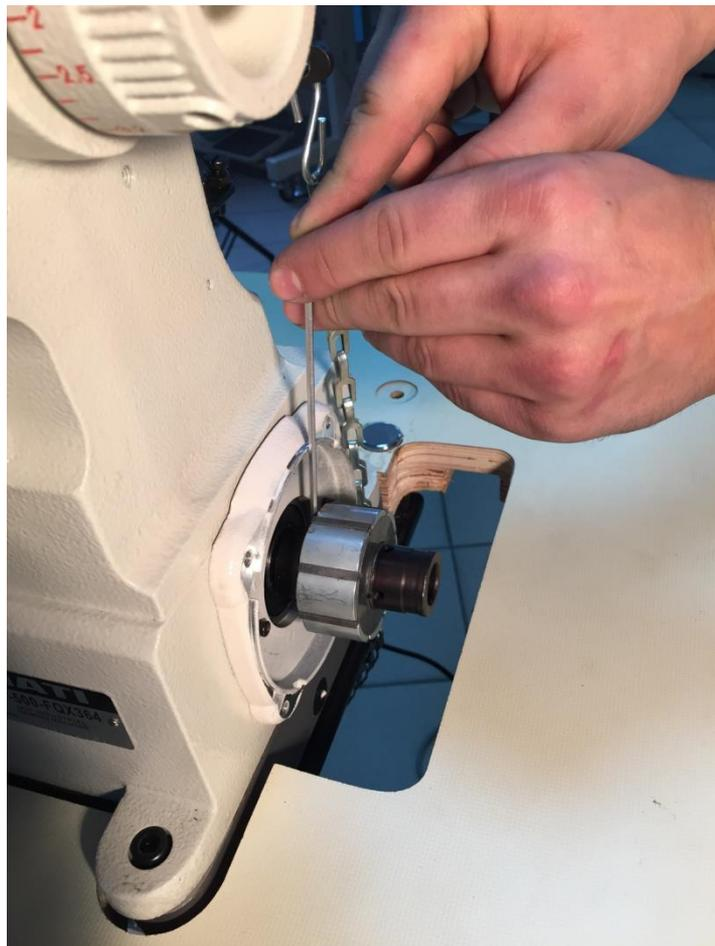
Шаг 6. Одеваем крышку двигателя и
